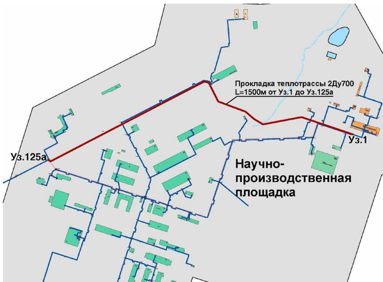
Рисунок 7.4. Строительство теплотрассы 2Ду700 от Узла 1 до Узла 125а
