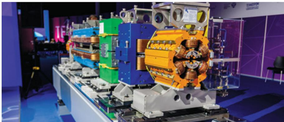
подставки — гирдеры, на которых размещаются элементы магнитной структуры основного накопителя ЦКП «СКИФ». Посадочные поверхности гирдеров изготавливаются с высокой точностью и снабжены прецизионными механизмами для регулировки положения элементов ускорителя и их фиксации.
